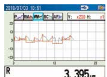
波纹度解析示例 (选择 CNOMO 标准时)
