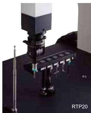
利用三坐标测量机的动力自动旋转的测头，内置TP20。(水平/垂直旋转时以间距 $15^\circ$ 转动)
